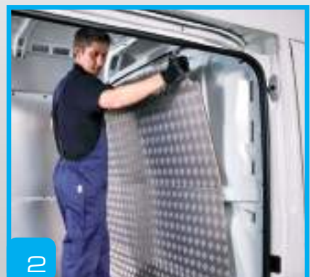
2 Bulkhead liners Revestimiento separador
