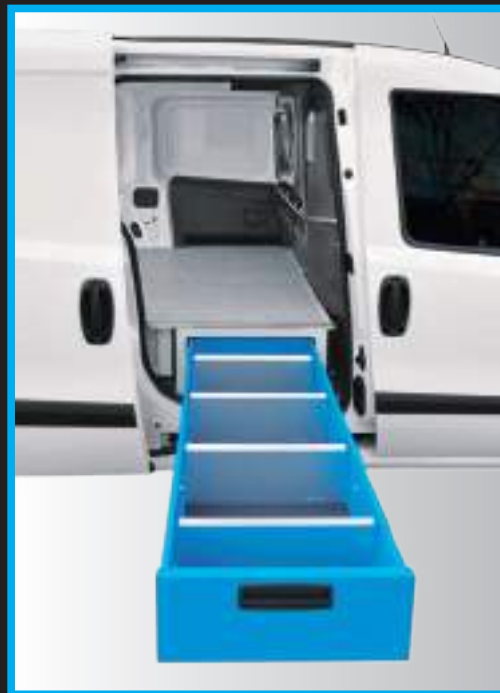
An underfloor drawer at the side door Cajón accesible desde la puerta lateral
